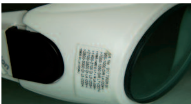
Abb. 27: Kennzeichnung der Schutzbrille: Schutzstufe, Wellenlänge, Betriebsart.
