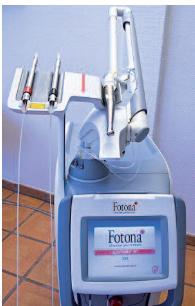
Abb. 6: Multiwave-Gerät bestehend aus gepulstem Nd:YAG- und Er:YAG-Laser.
